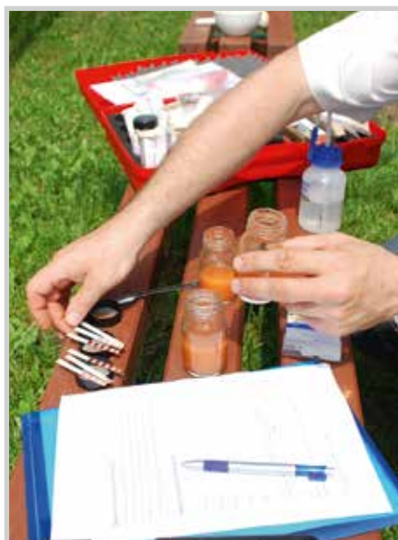
Badanie zasolenia cegły „in situ”
